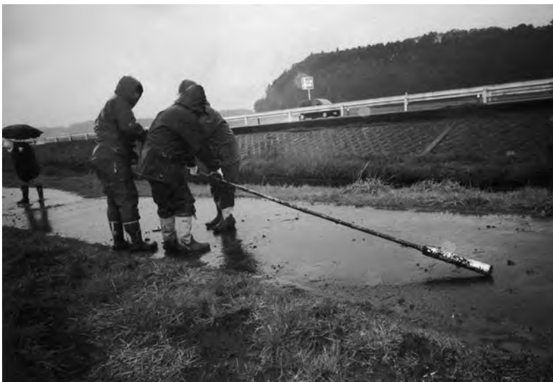
図5 シンウォール型サンプラーを引き上げた状況 (写真: 清永).
