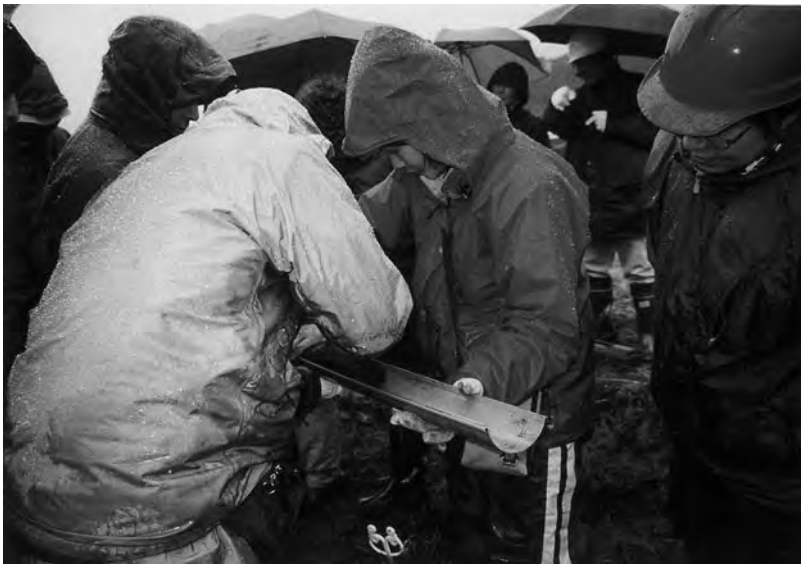
図4 シンウォール型サンプラーからの試料取り出し状況 (写真: 清永).
