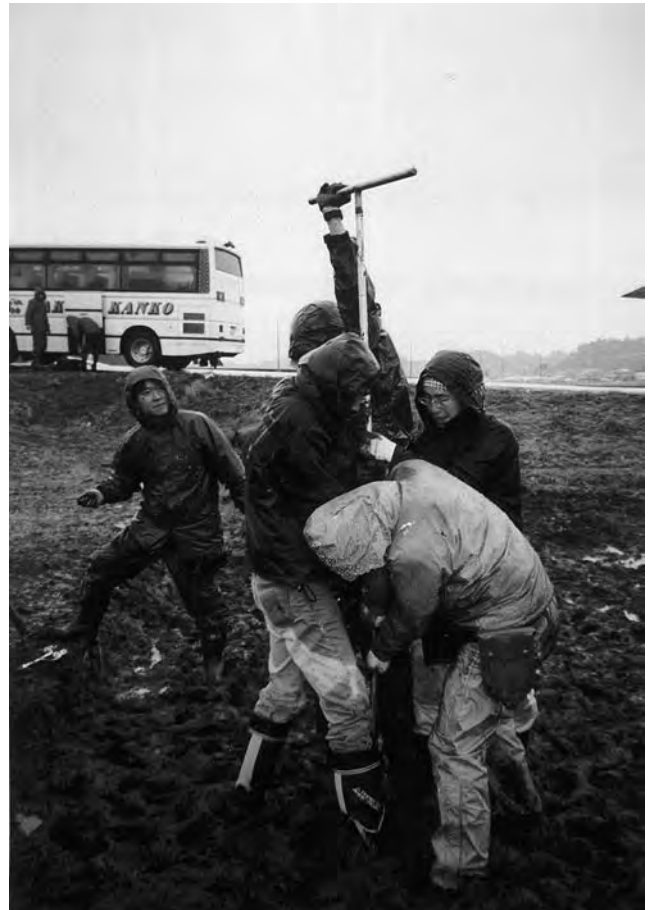
図7 ロシア式サンプラーによる掘削状況(写真:清永).
