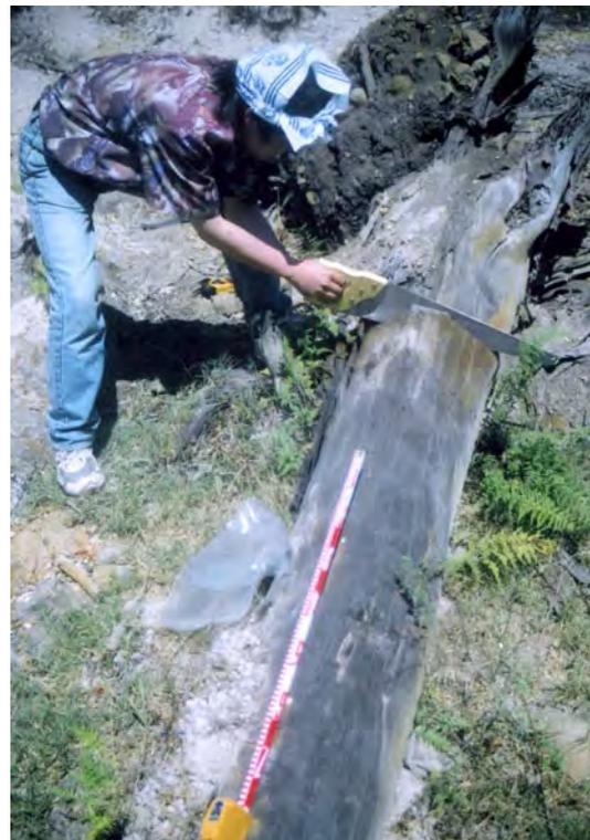
図2 試料の採取。横倒しになって埋もれていた木の一部分が、火砕流堆積物の浸食により露出したところから、表皮の残っている箇所を中心に、のこぎりで切って、試料を採取した(写真の中で採取しているのは小田)。
