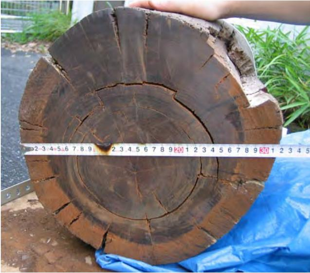
図5 試料の断面に見られる成長輪。
