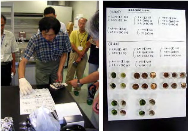
図2 左：電気炉に入れる標本を準備する小椋先生，右：るつぼに入れられた現世植物（湯本貴和氏撮影）。
