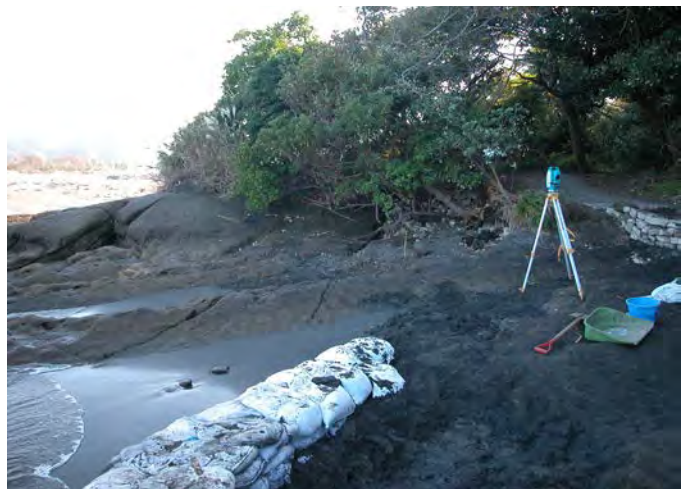
写真3 打ち寄せる波と土嚢。汀線ぎりぎりに土嚢を積んで調査している。
